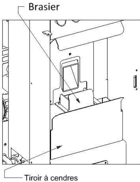
Figure 6. Chambre de combustion
