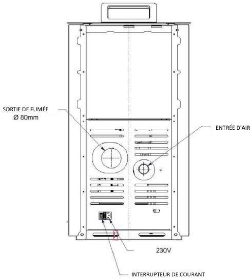
Figure 2. Partie arrière du poêle
